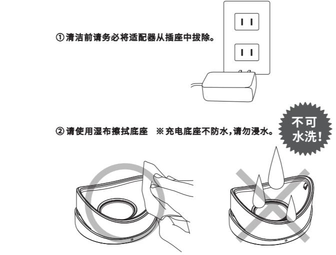
△充电底座切勿进水，以免产生故障、触电、短路及火灾等。
