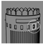
**Entfernen Sie die** Kompressionseinheit und überprüfen Sie, ob die Lasche im Loch ganz rechts ist.
