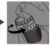
Falls nicht, halten Sie die Kompressorhülle wie abgebildet fest und drehen Sie den Kompressor so, dass die Lasche zum Loch ganz rechts gelangt.
