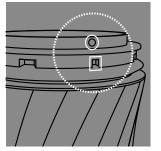
**Entfernen Sie die Elastomer-**Manschette und vergewissern Sie sich, dass sich die Kompressionseinheit und das Gehäuse in der richtigen Position befinden.
