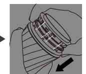
Installieren Sie die Kompressionseinheit, indem Sie sie direkt komplett in das Gehäuse einschieben.
