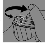
Falls Sie in einer anderen Position sind, halten Sie das Gehäuse wie abgebildet fest und drehen Sie nur die Kompressionseinheit zurück in die richtige Position.
