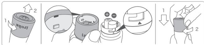
●電池が勢良く飛び出す恐れがありますので、キャップを上にした状態でボディから外してください。
