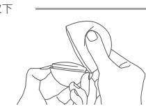
形成缝隙后用手指顶开,取下本体
