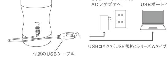
①接続前にご使用のACアダプタ、またはパソコンのUSB規格が本製品の規格と合っているか必ずご確認下さい。
